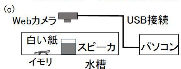
図 2 BOS-IR 実験装置 (a)全体写真、(b)測定時のパソコン画面、(c)配置図
