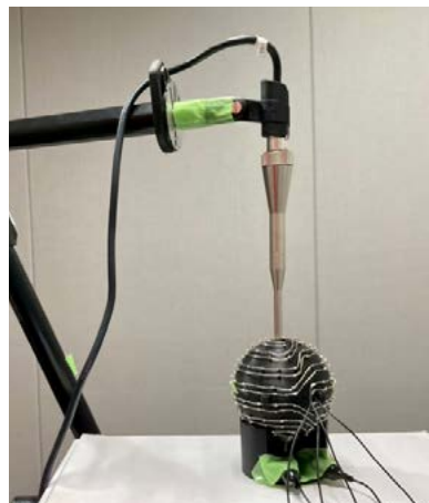
図 10 球状の振動子アレイとマイクロホン
