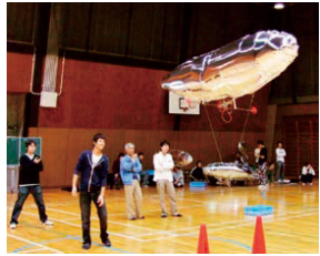
ワンチップマイコン、超音波距離センサ、磁気センサ等を搭載して自律飛行する飛行船を設計・製作します。
