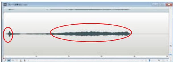
実際に練習で録音した音声波形と、前項で作成した理想的なフルート音声波形との差分をとって表示します。左図が差分波形です。吹き始めの部分と、1.4秒から3.9秒付近にかけて差分波形が大きく音質が低下している様子がわかります。
