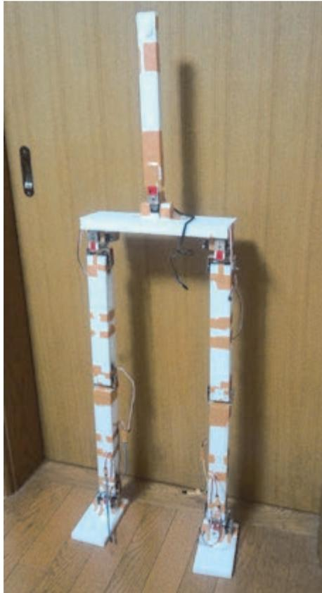
現在、静止状態での姿勢制御までは可能となったが、歩行動作の実現には至っていない。この原因は、3DCAD によるモデリングと金属加工の技術の習得、ジャイロセンサのプログラムの理解に予定より時間がかかったことが挙げられる。
