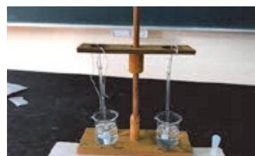
簡易浸透圧測定装置のサンプル
