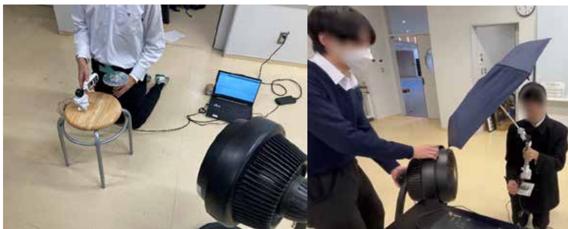
左図：自作風向速センサの精度を検証する様子 右図：自動回転傘の動作テストをする様子
